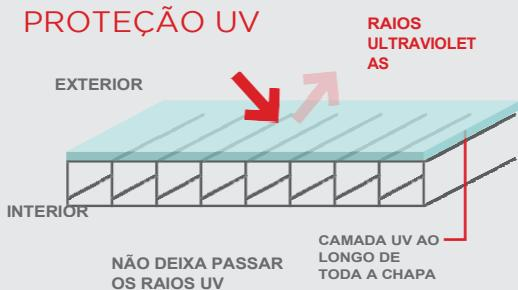
As chapas alveolares Klar incorporam uma camada coextrudada de proteção UV, aplicada de forma uniforme em toda a superfície e com a porcentagem ideal para evitar o amarelamento e a perda de luminosidade ao longo do tempo. Graças a essa tecnologia, garantem alta durabilidade e possuem 10 anos de garantia sobre a transmissão de luz.
